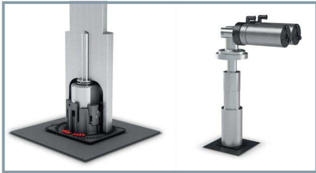
**Bild 2.** Prinzip des torsionalen Verschweißens. Hier werden Rund-Sonotroden verwendet © Magna Exteriors
